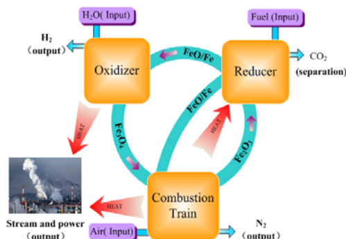
图 10 化学循环燃烧原理示意图 Fig.10 Principle diagram of chemical looping combustion
