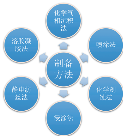
图 2 透明超疏水的制备方法
